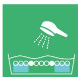
Dopo l'esposizione bagnare internamente ed esternamente il quadro, lasciare il quadro bagnato per qualche istante e sciacquare successivamente con getto d'acqua sul lato stampa fino alla completa apertura dei dettagli del disegno. Se possibile, si consiglia di immergere il quadro in acqua a temperatura ambiente per circa cinque minuti prima dello sviluppo.
